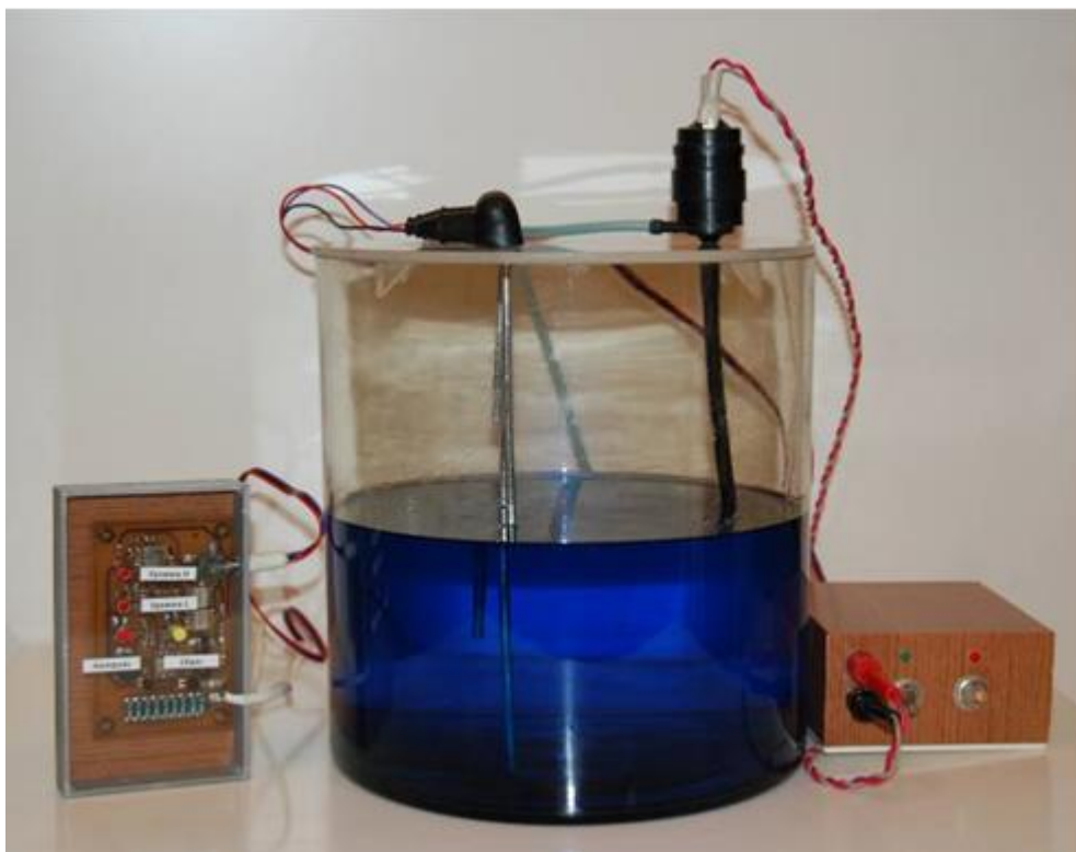
Рисунок 1 – Схема измерительной установки емкостного уровнемера
