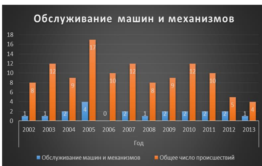
Рисунок 2 – Доля происшествий при обслуживании машин и механизмов по отношению к общему числу смертельных несчастных случаев.
