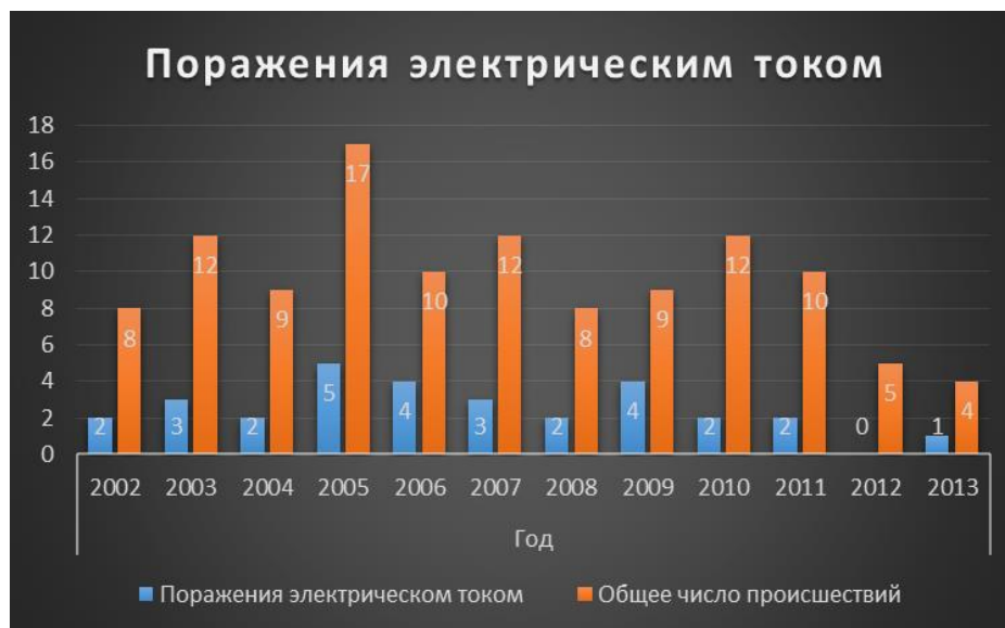
Рисунок 4 – Доля несчастных случаев со смертельным исходом при поражении электрическим током по отношению к общему числу несчастных случаев со смертельным исходом
