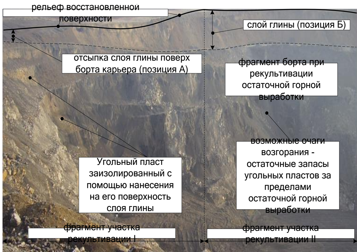
Рис.1. Схема рекультивации нарушенных земель при открытой разработке запасов угля отработанных подземным способом.
