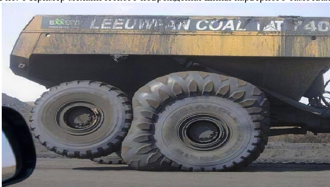
Рис. 2 Пример теплового повреждения шины карьерного самосвала
