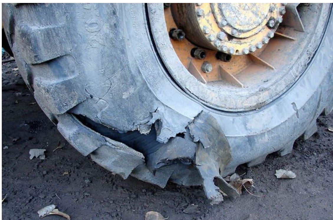
Рис. 1 Пример механического повреждения шины карьерного самосвала
