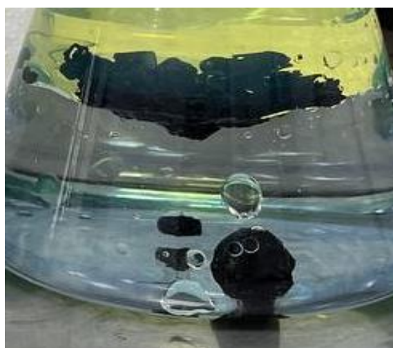
Рисунок 2 – Плёнка дизельного топлива на поверхности осевших частичек сорбента МИУ-С
