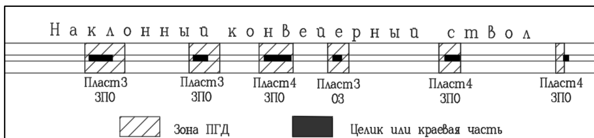
Рис. 4. Схема расположения предохранительных целиков и краевых частей пластов 3, 4 по трассе наклонного конвейерного ствола
