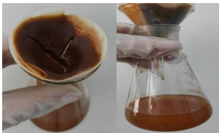
Рис.3. Осадок после осаждения гидроксидом аммония
