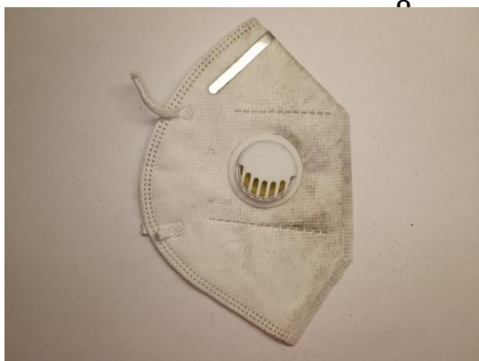
Рис.7.Лицевая сторона респиратора, эксперимент с земляной пылью.
