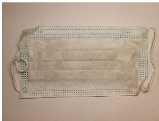
Рис.3.Лицевая сторона маски, эксперимент с хвойной пылью.
