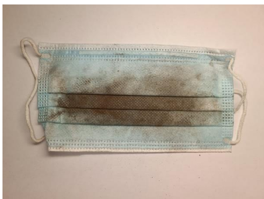
Рис.3.Лицевая сторона маски, эксперимент с хвойной пылью.
