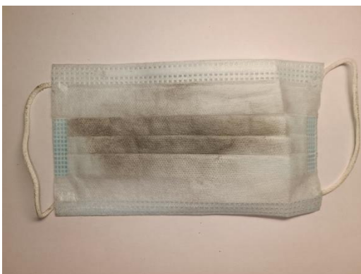
Рис.6.Тыльная сторона маски, эксперимент с угольной пылью.
