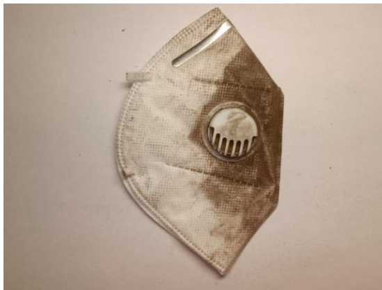
Рис.9.Лицевая сторона респиратора, эксперимент с хвойной пылью.
