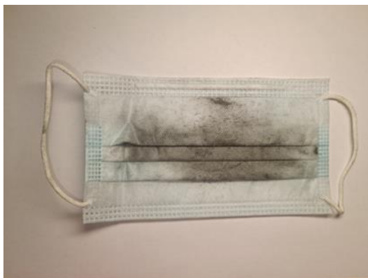
Рис.5.Лицевая сторона маски, эксперимент с угольной пылью.
