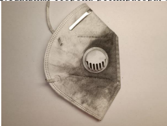
Рис.11 Лицевая сторона респиратора, эксперимент с угольной пылью.
