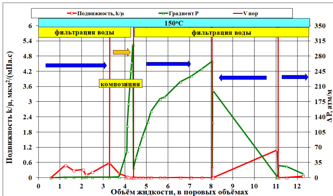
Рисунок 2 – Фильтрационные характеристики модели пласта Ярегского месторождения (нефтенасыщенный песчаник) при 150 °С. Газовая проницаемость – 3,782 мкм 2
