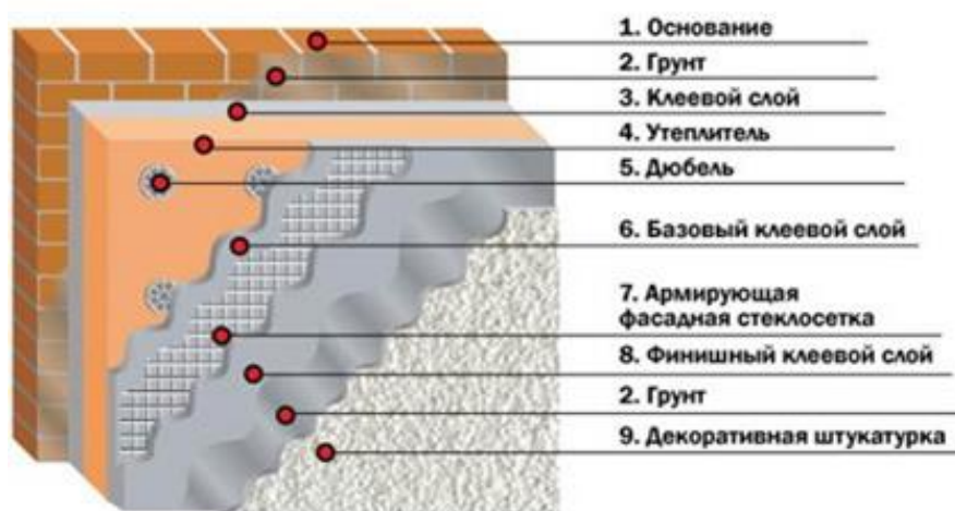
Рис. 1. Составная конструктивная схема утепления фасада по системе «мокрого» типа
