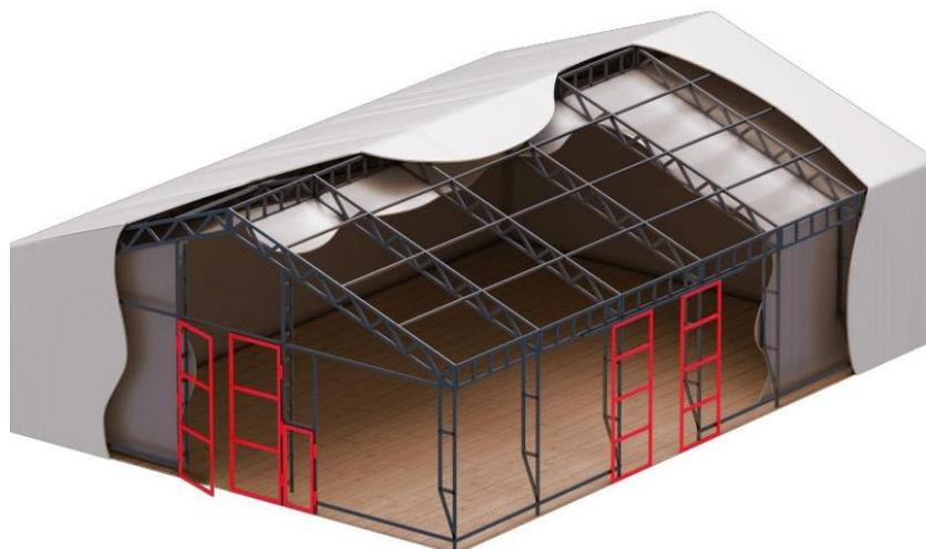
Рис. 1. Каркасно-тентовое здание промышленного назначения
