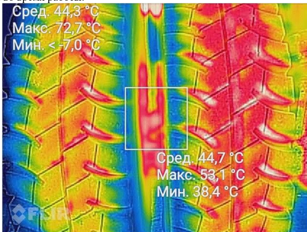
Рис. 3. Съёмка тепловизором шины самосвала во время эксплуатации
