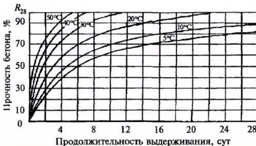
Рис. 1. График набора прочности бетона М400
