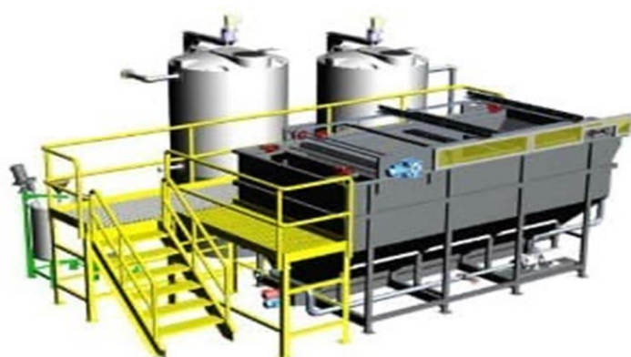
Рис 3. Аппарат для осветления сточных вод. -Химический (деминерализация)
