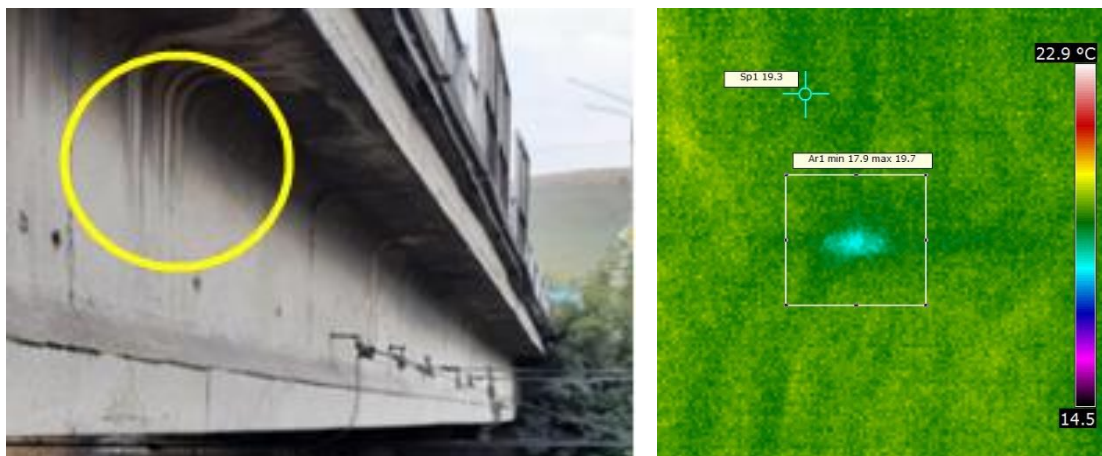
Рис. 3. Фото и термограмма бетонного пролета моста
