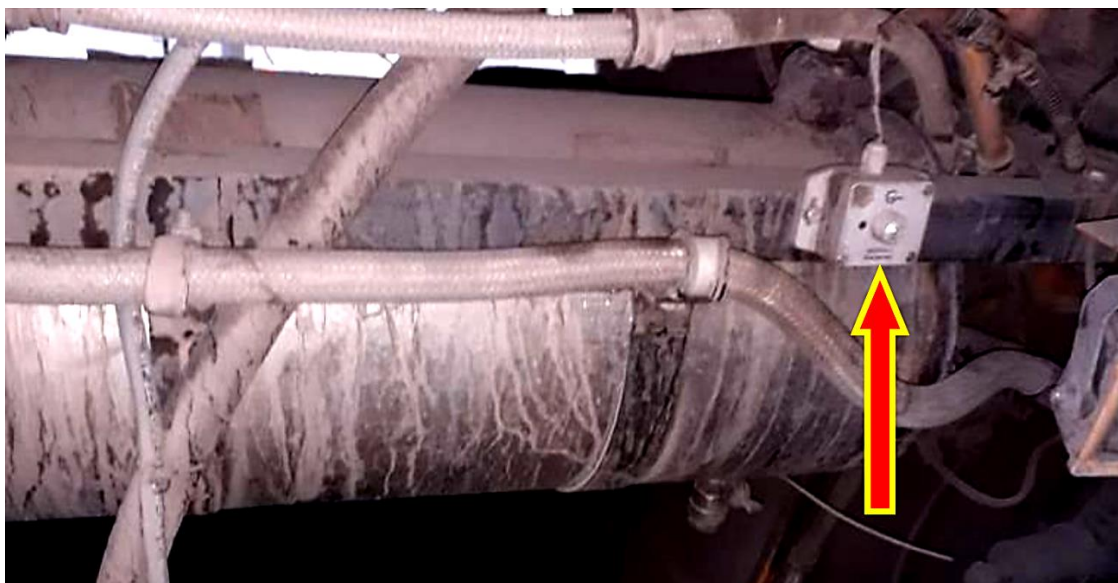
Рис. 2 Место установки первого БД на специализированной платформе испарителя-регазификатора под палубой газодизельного карьерного самосвала серии БелАЗ-7513
