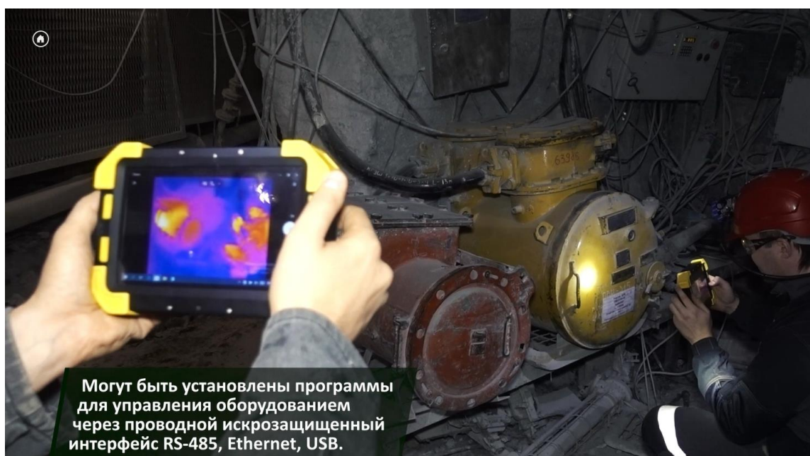
Рисунок 4 – Использование тепловизора в условиях шахты
