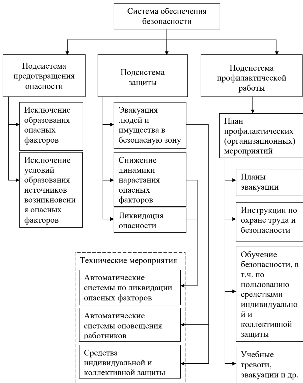
Рисунок 3 (Блок-схема 1) – Система обеспечения пожарной безопасности объектов
