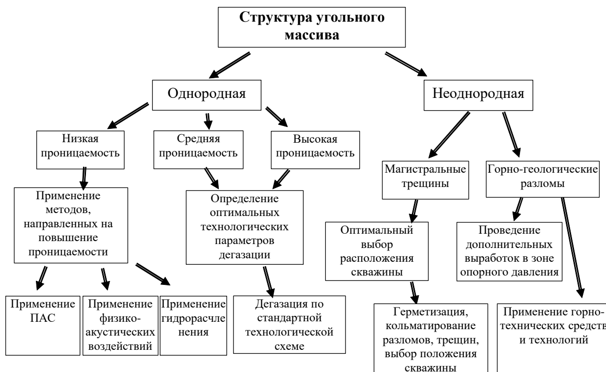
Рис. 1. Схема выбора способа интенсификации технологии дегазации на основе структурных особенностей угольного пласта
