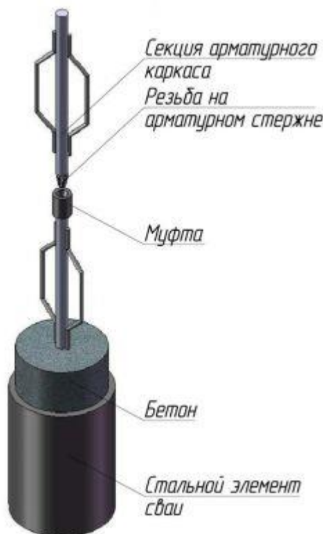
Рис. 1. Конструкция трубобетонной сваи.
