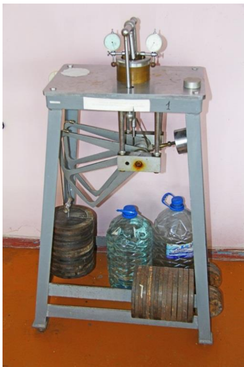
Рисунок 2. Общий вид компрессионного прибора КПр-1, Гидропроект
