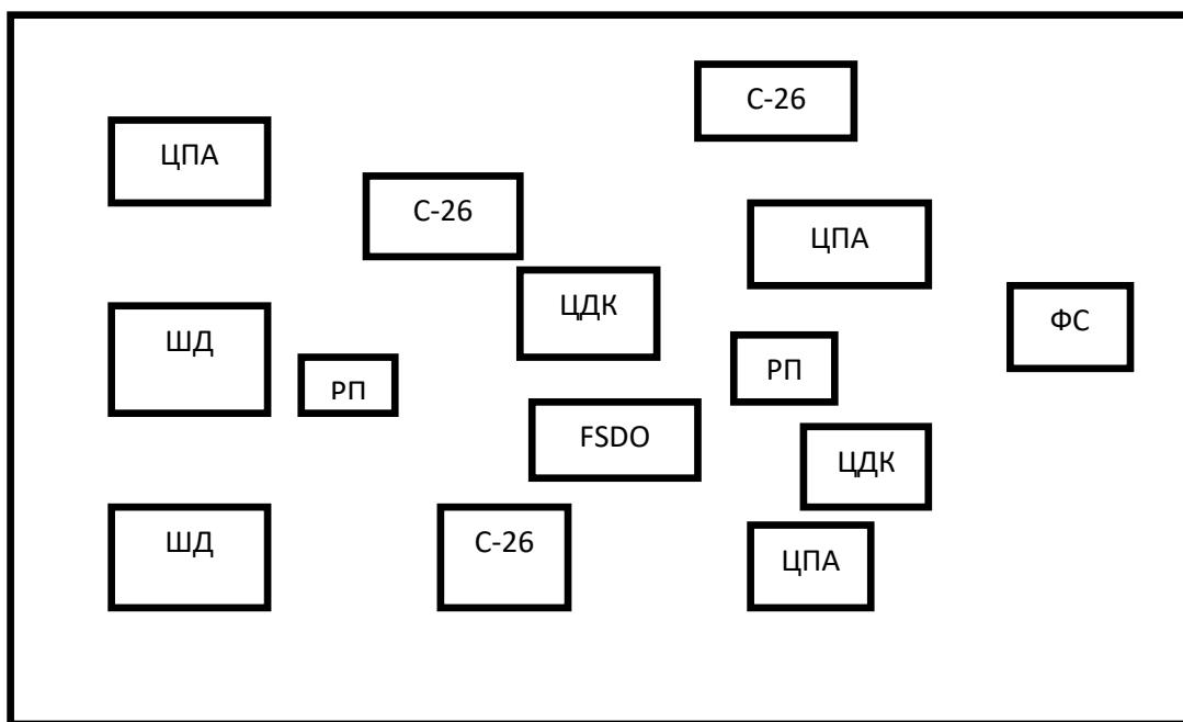
FSDO – фуговальный станок; ШД - шлифовальный; ШП – шипорезный; С-26 – сверлильный; РП – реймусовый; ФС – фрейзерный; ЦДК – прирезной; ЦПА – торцовочный
