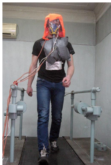
Рисунок 2 – Испытания самоспасателя СГЭ с участием испытателя-добровольца на беговой дорожке
