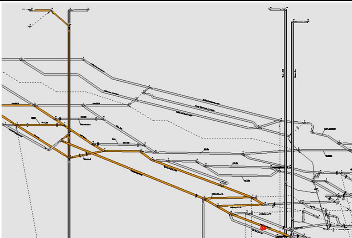
Рис. 2. Определение зоны загазованности при моделировании пожара в сети горных выработок шахты имени Губкина.
