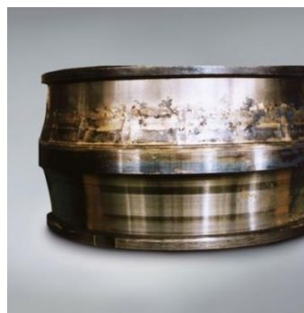
Рисунок 1. Дефект двухрядного подшипника: а) износ тел качения подшипника качения; б) износ беговой дорожки подшипника качения.
