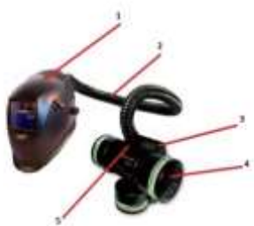
Рис.1 Турбоблок «Муссон»: 1 - щиток электрогазосварщика (модифицированный под работу турбоблока); 2 - воздушный шланг для подачи в рабочую зону чистого воздуха; 3 - аккумуляторная батарея; 4 - сменный фильтр (3 штуки); 5 - бесщёточный электродвигатель.
