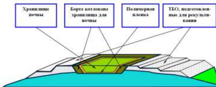
Рис. 1. Схема формирования архитектуры свалочного тела и хранилища загрязненной почвы в ходе работ по ликвидации и рекультивации свалки ТБО
