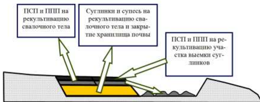
Рис. 3. Схема совмещения работ по формированию защитных слоев и рекультивации земельного участка выемки ПСП, ППП и суглинков
