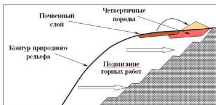
Рис. 5. Схема к определению объема и источника формирования почвенной смеси для рекультивации бортов карьера
