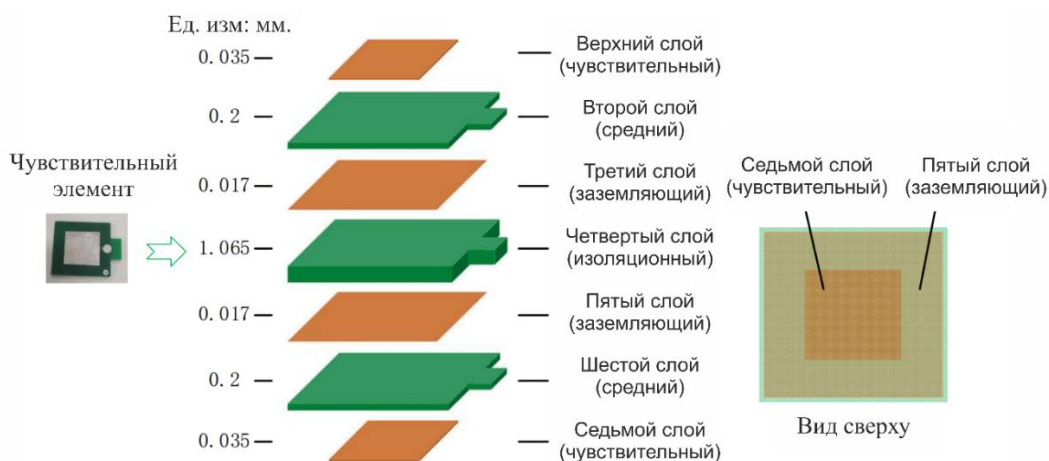
Рисунок 1.16 – Структурная диаграмма чувствительного элемента датчика напряжения
