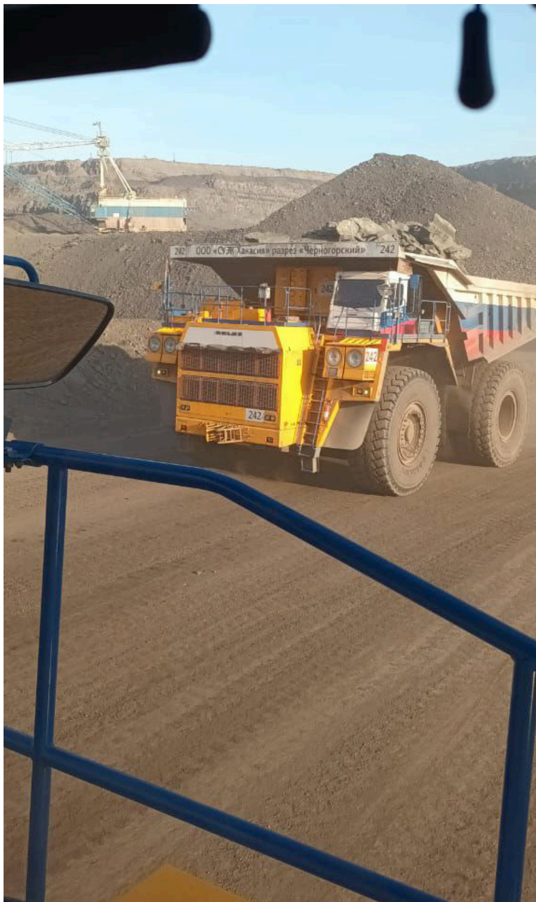
Рисунок 3.6 – Негабарит в кузове автосамосвала
