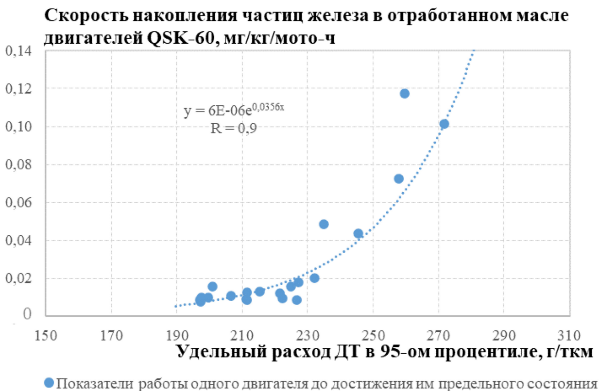
Рисунок 2.6 – Связь скорости накопления частиц железа в отработанном масле двигателей и удельного расхода ДТ в 95-м процентиле по автосамосвалам БелАЗ-75306 разреза «Черногорский» за период 2021 2024 гг.
