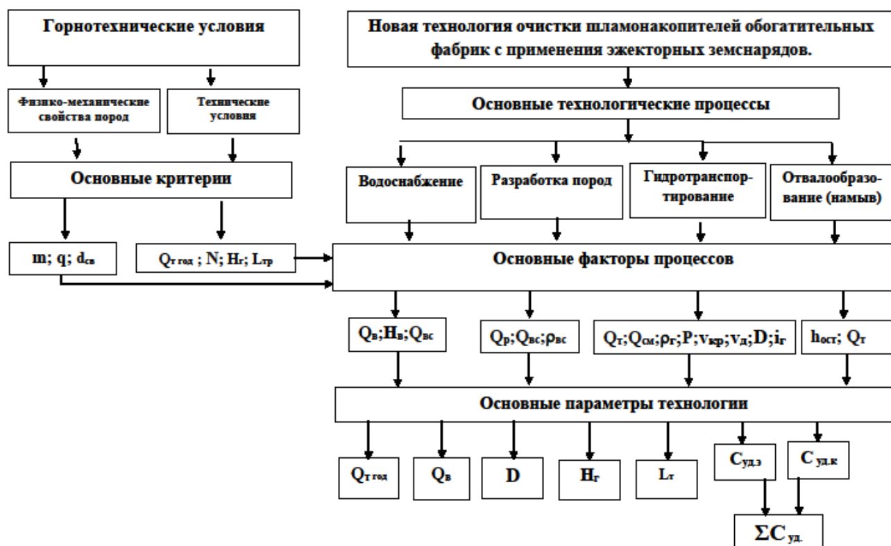
Рисунок 2.1 – Схема взаимосвязи критериев горнотехнических условий и основных факторов технологических процессов технологии очистки шламохранилищ с применением эжекторного земснаряда
