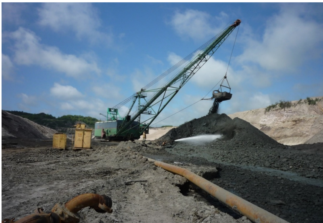
Рисунок 1.6 – Применение экскаваторного рыхления породы перед гидромониторным размывом
