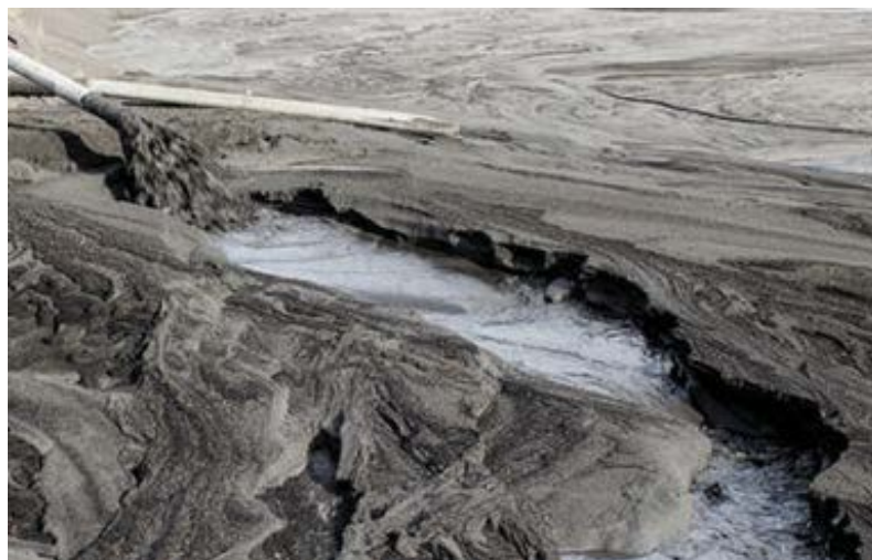
Рисунок 1.1 – Намыв шламов в шламохранилище
