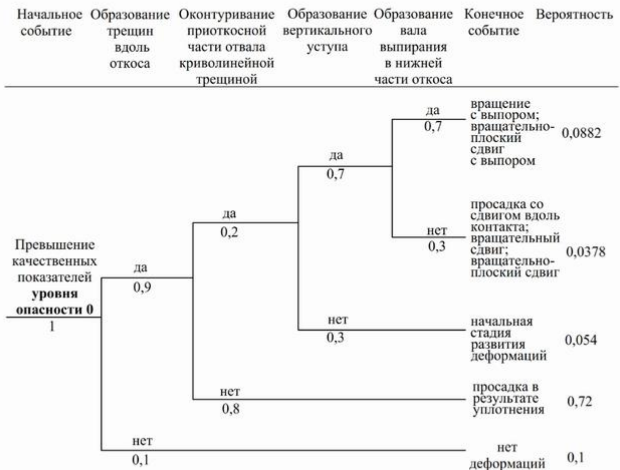
Рисунок 2.5 – "Дерево событий" развития деформации природно-технической системы "отвал-основание"
