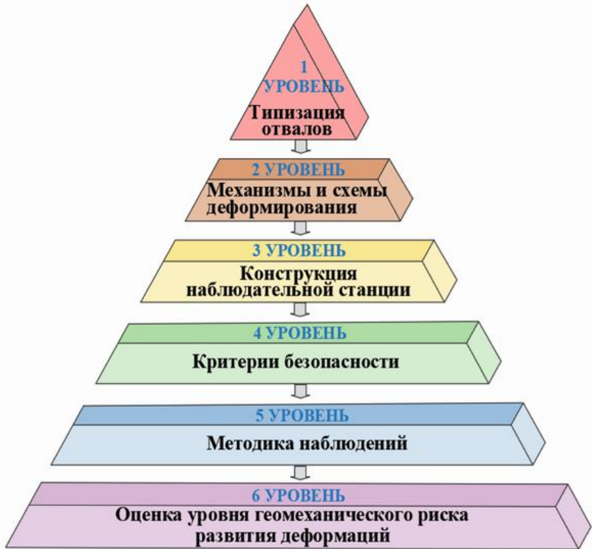
Рисунок 2.2 – Иерархическая структура системы геомеханического мониторинга природно-технической системы "отвал-основание"
