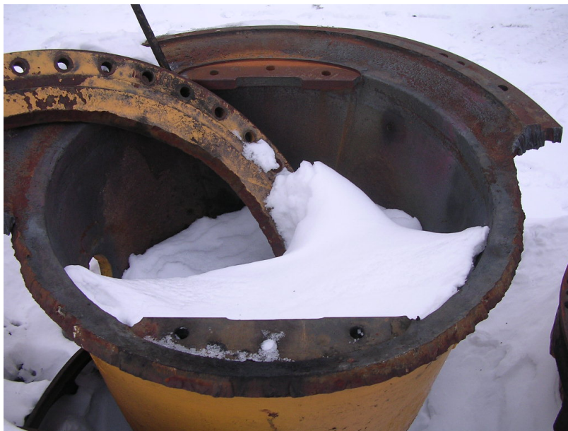
Рисунок 11. – Разрушенный корпус РМК
