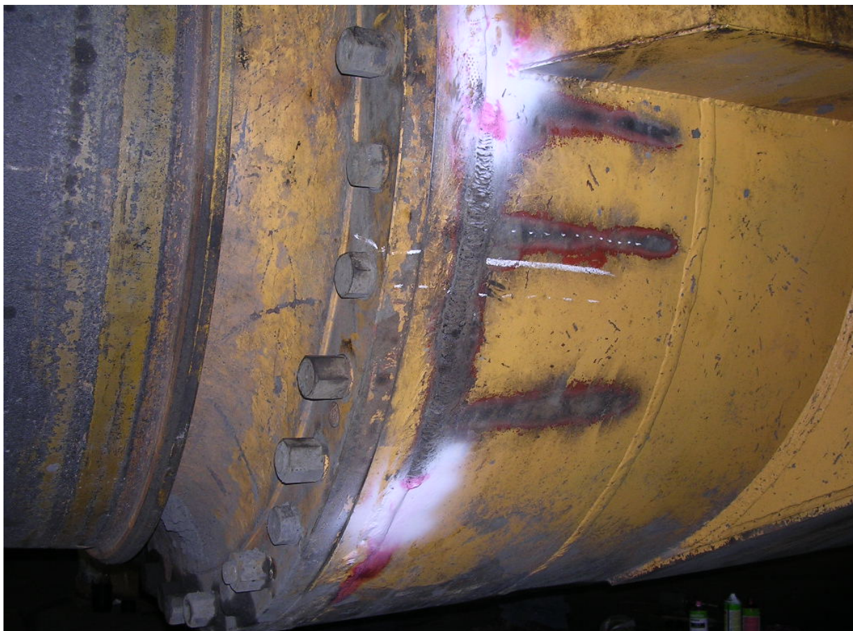
Рисунок 12. – Картер заднего моста после ремонта
