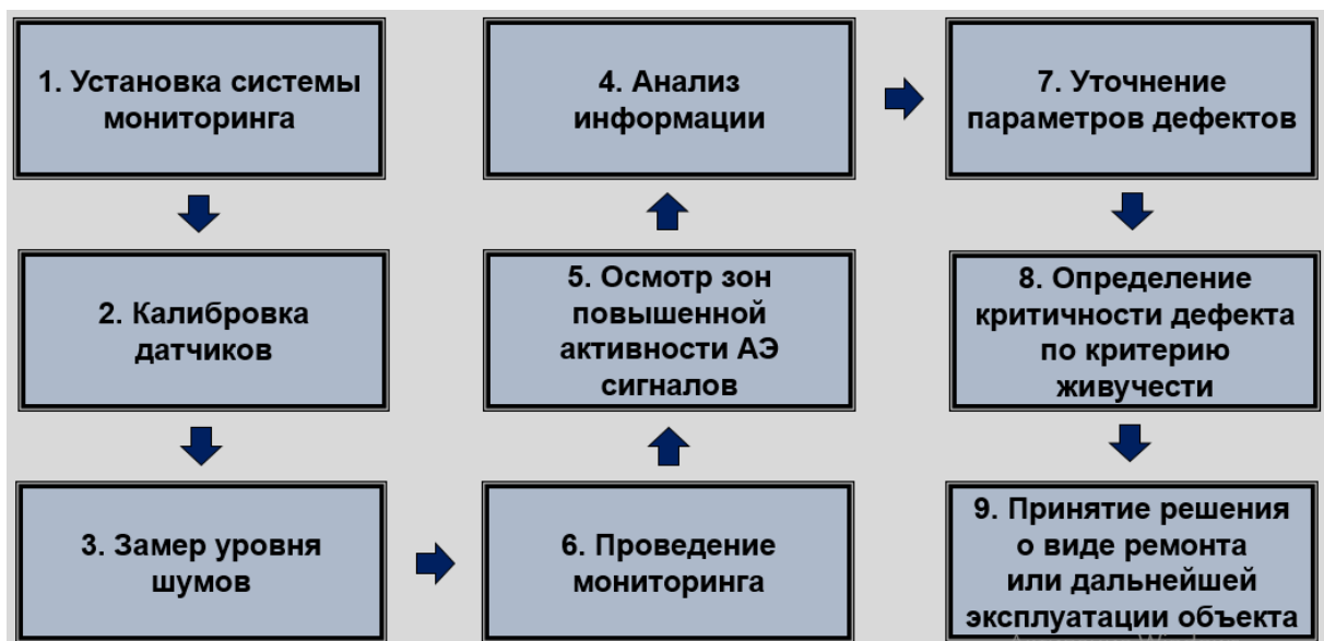
Рисунок 26. – Методика проведения АЭ мониторинга
