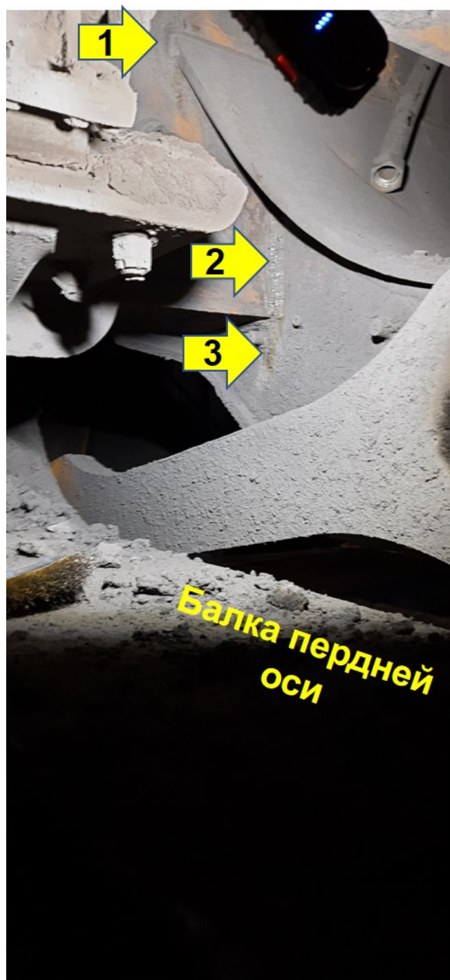
Рисунок 46. – Отремонтированный участок рамы у датчика №8
