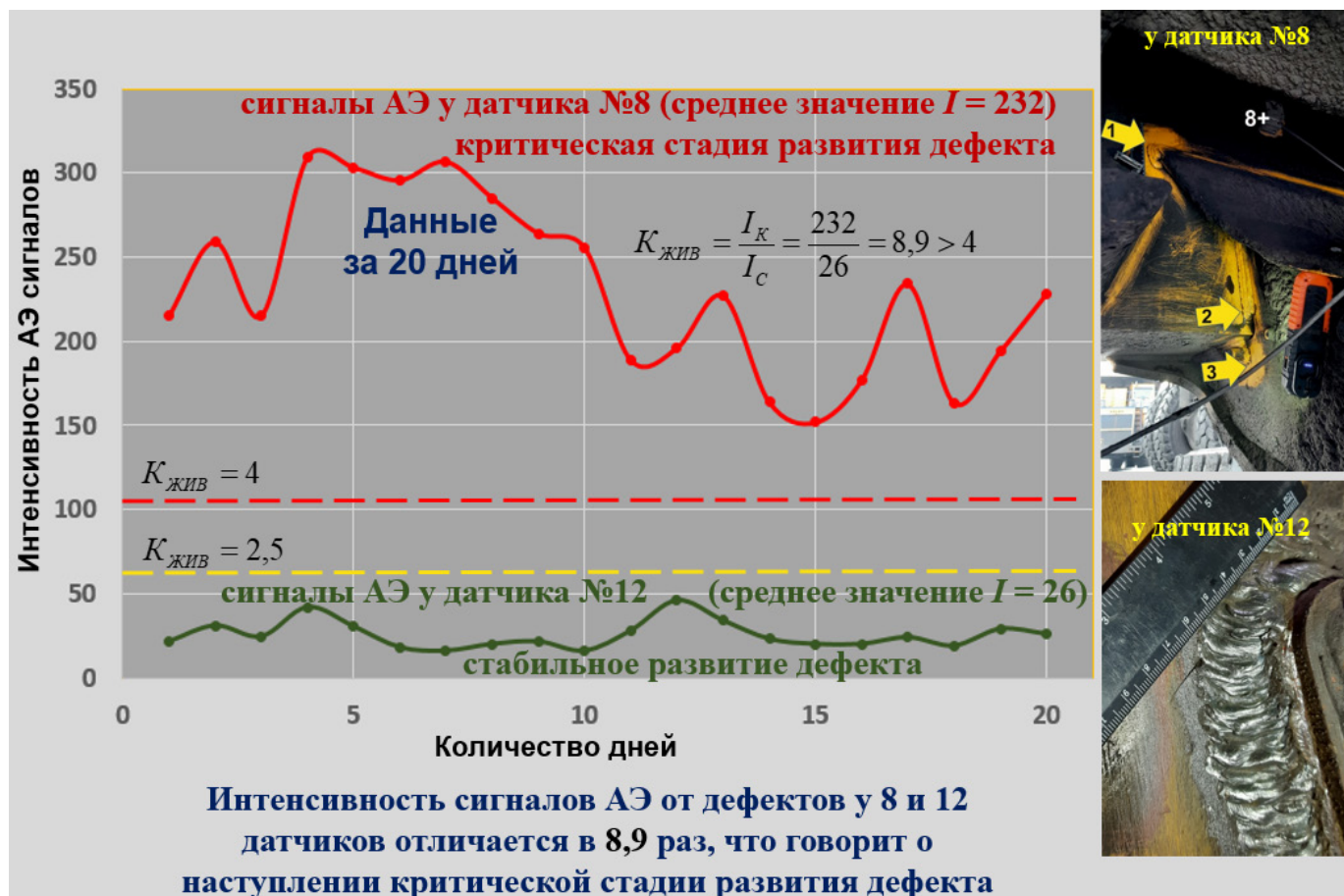
Рисунок 47. – Интенсивность АЭ сигналов за месяц (датчики № 8 и 12)
