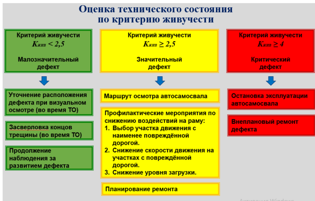
Рисунок 48. – Оценка технического состояния по критерию живучести
