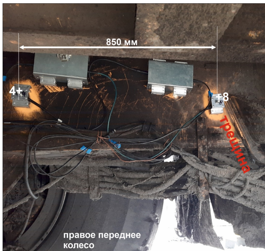
Рисунок 31. – Фото установленных на раме датчиков № 4 и 8
