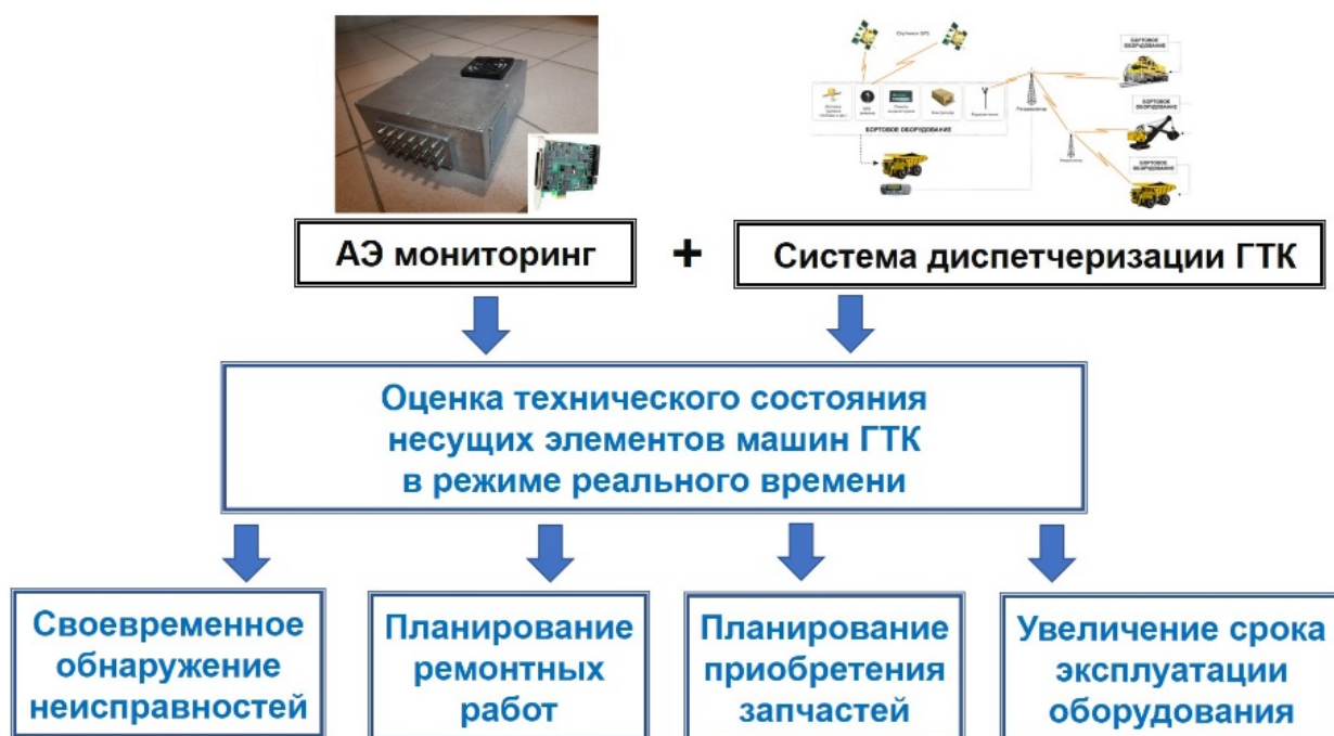
Рисунок 56. – Результат интеграции АЭ мониторинга в систему диспетчеризации ГТК
