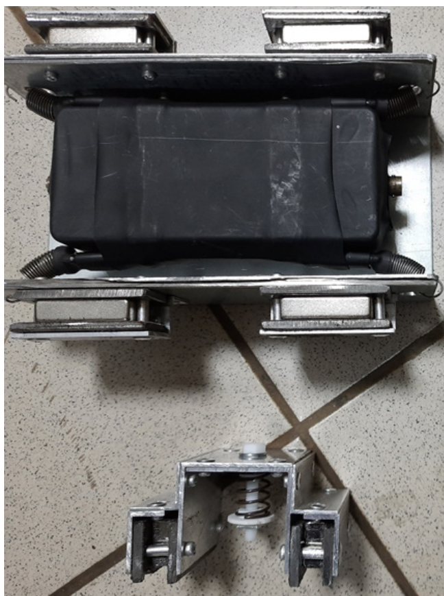
Рисунок 25. – Магнитные держатели для предусилителей и датчиков
