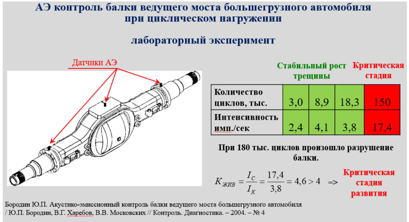
Рисунок 8. – АЭ контроль балки ведущего моста большегрузного автомобиля при циклическом нагружении [95]
