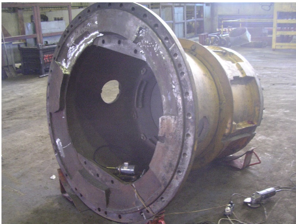
Рисунок 18. – Демонтированный корпус РМК
