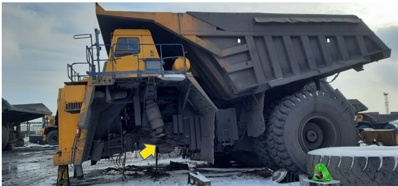
Рисунок 45. – Автосамосвал с демонтированной передней осью
