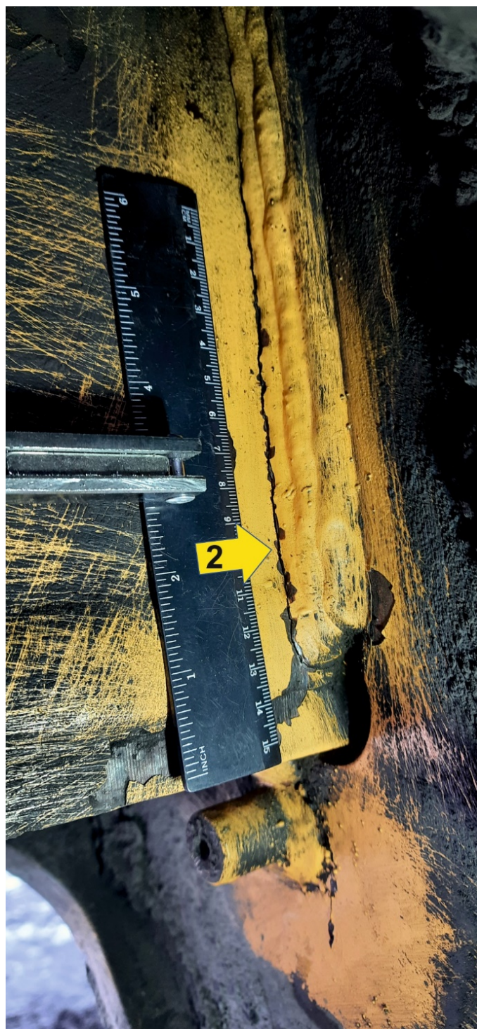
Рисунок 44. – Дефекты рамы, в районе 2-ой перемычки (датчик № 8)
