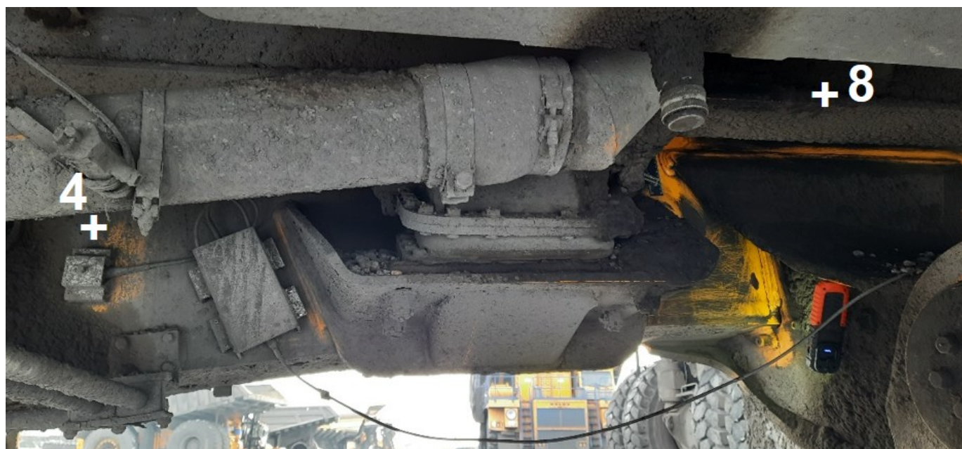
Рисунок 34. – Фото установленных на раме датчиков № 4 и 8
