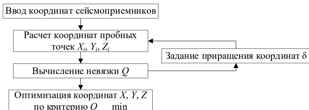
Рис. 2.8. – Блок-схема программы для ЭВМ «Метод определения координат очага динамического явления при сейсмическом мониторинге»
