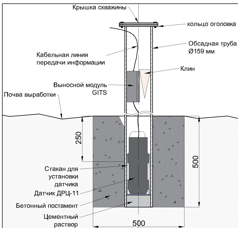
Рис. 2.3. – Схема размещения подземного датчика и выносного модуля на бетонном постаменте
