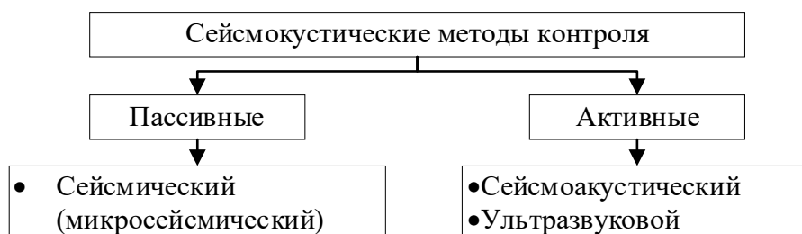
Рис. 1.8 – Сейсмоакустические методы контроля состояния и свойств породного массива
