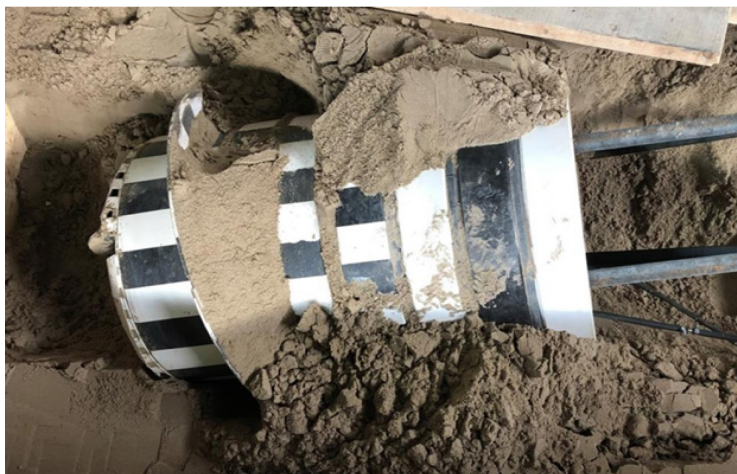
Рисунок 1.4 – Демонстрационный образец геохода с НИО выпуклой геликоидной формы
