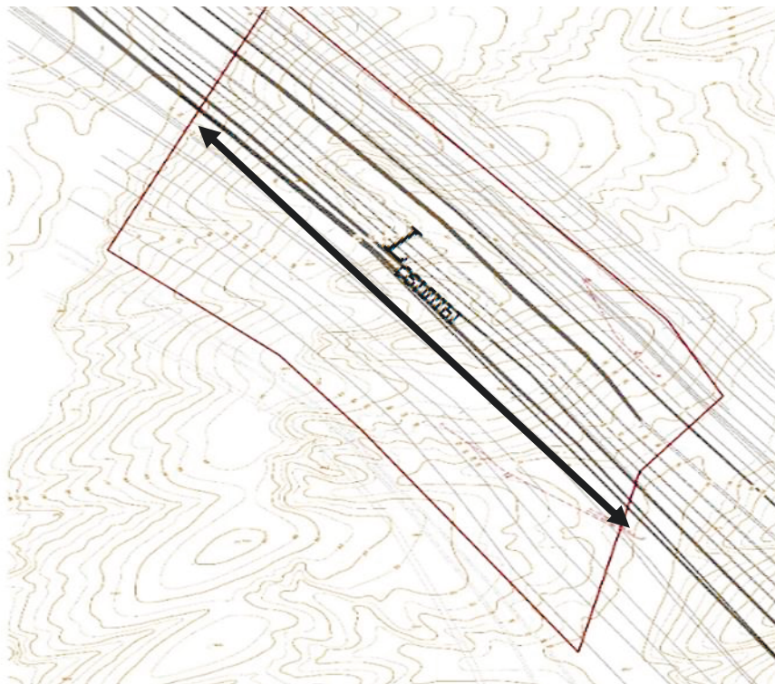
Рисунок 3.16 – Схема выхода свиты пластов под наносы
