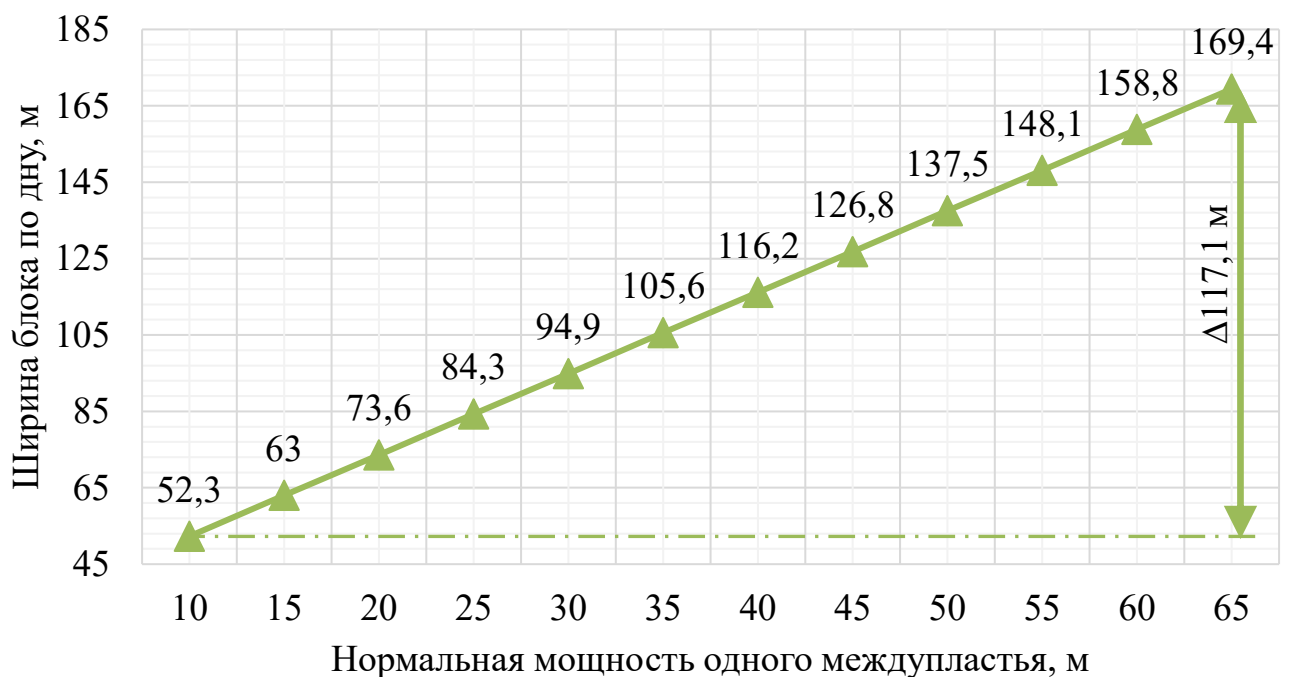
Рисунок 3.21 – Зависимость изменения ширины блока по дну при значениях нормальной мощности одного междупластья от 10 до 65 м
