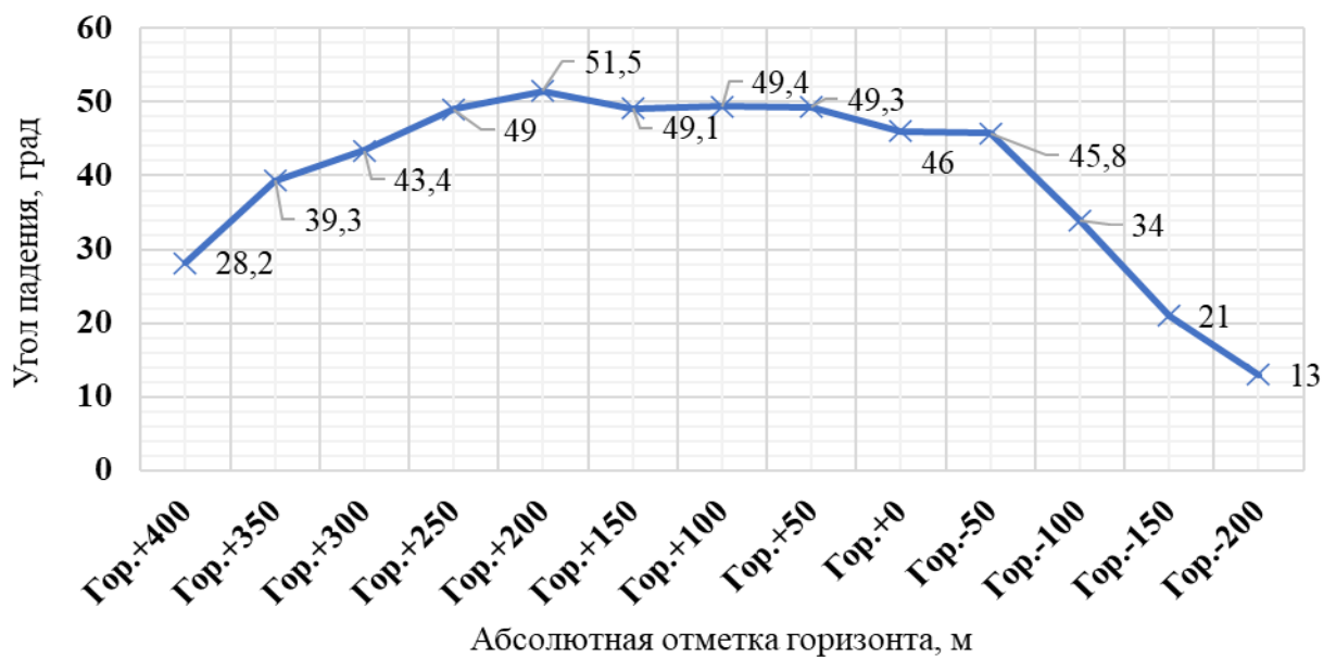
Рисунок 3.7 – Зависимость изменения средневзвешенных углов падения пластов в свите перспективных участков от глубины разработки
