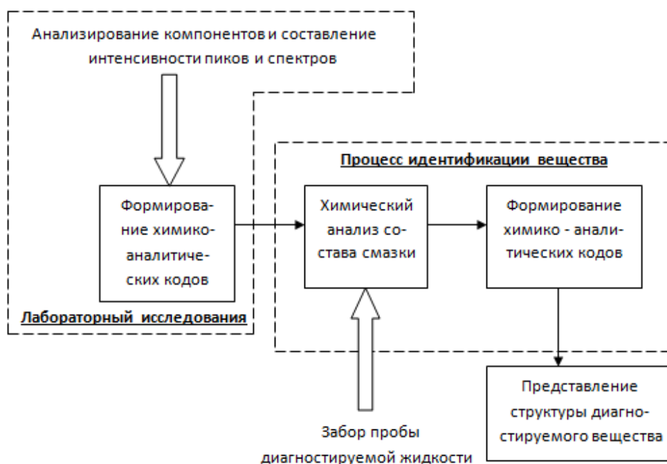
Рисунок 1.2 – Блок-схема процесса химико-аналитической диагностики
