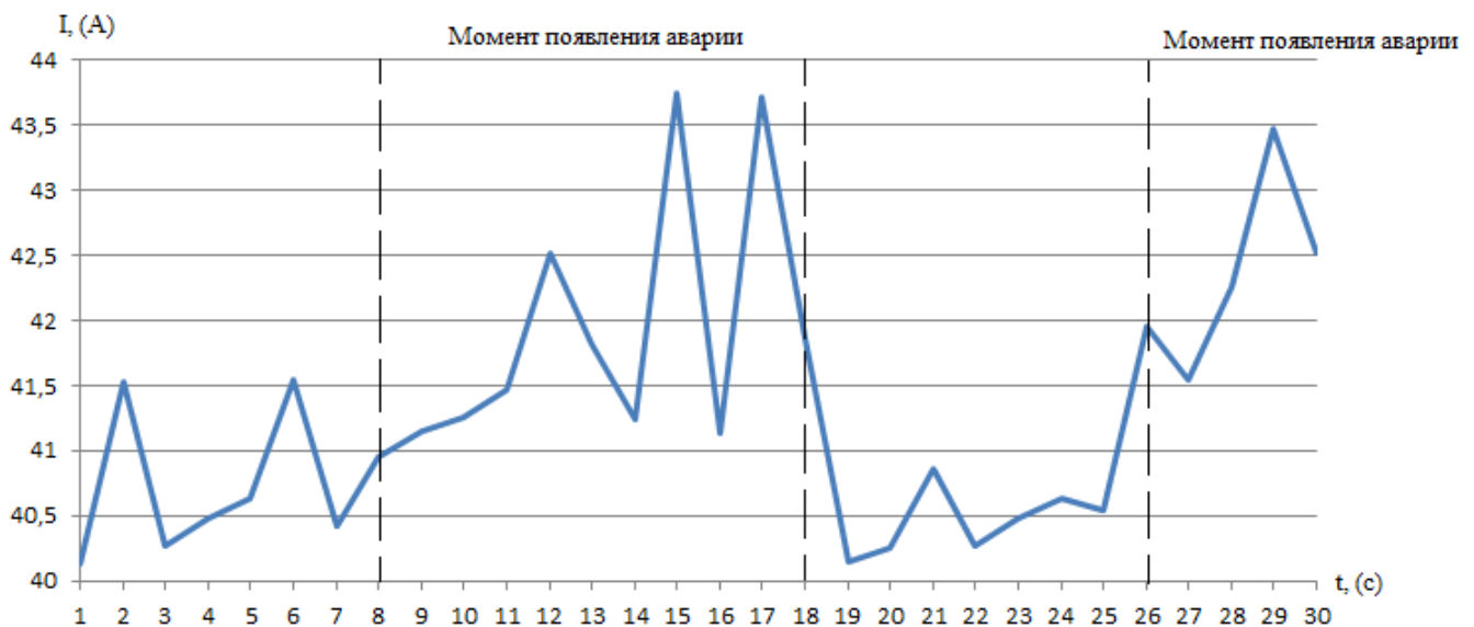
Рисунок 3.9 – График изменения тока статора при сходе ленты в процессе работы в номинальных условиях и задевании защитного желоба разгрузочной телеги
