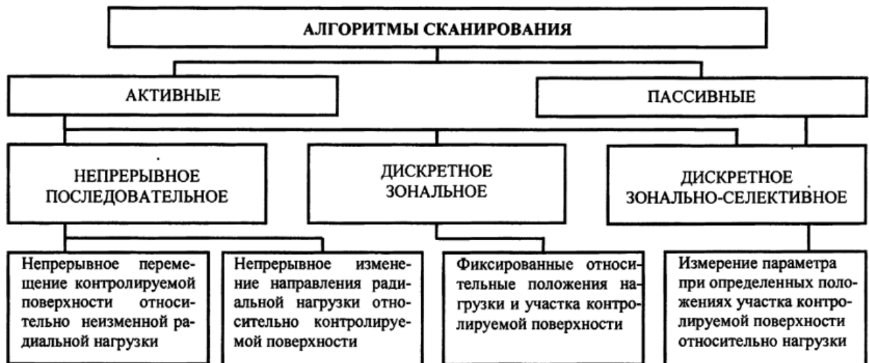
Рисунок 1.4 – Алгоритмы сканирования при поиске дефектов с использованием электрорезистивного метода
