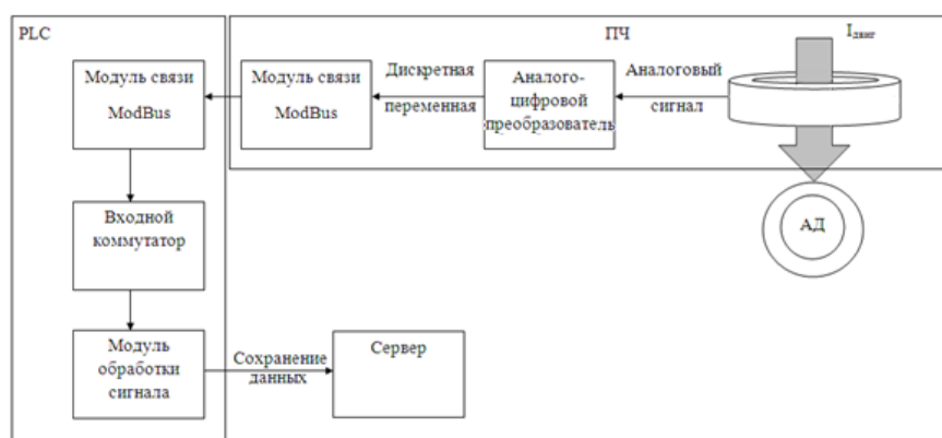
Рисунок 3.1 – Функциональная схема фиксации регистрируемых параметров
