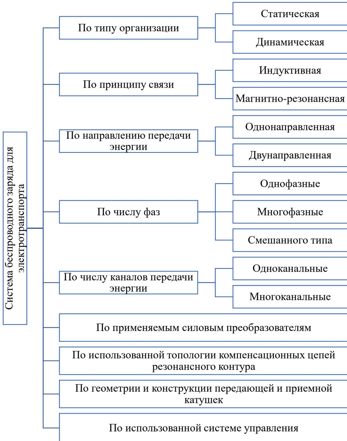
Рисунок 1.11 - Классификация систем беспроводного заряда для электротранспорта
