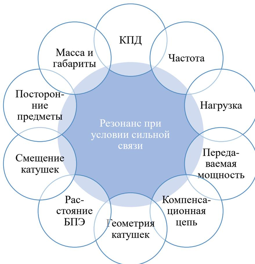
*Рисунок 3.1 - Факторы, влияющие на эффективность системы беспроводного заряда*
