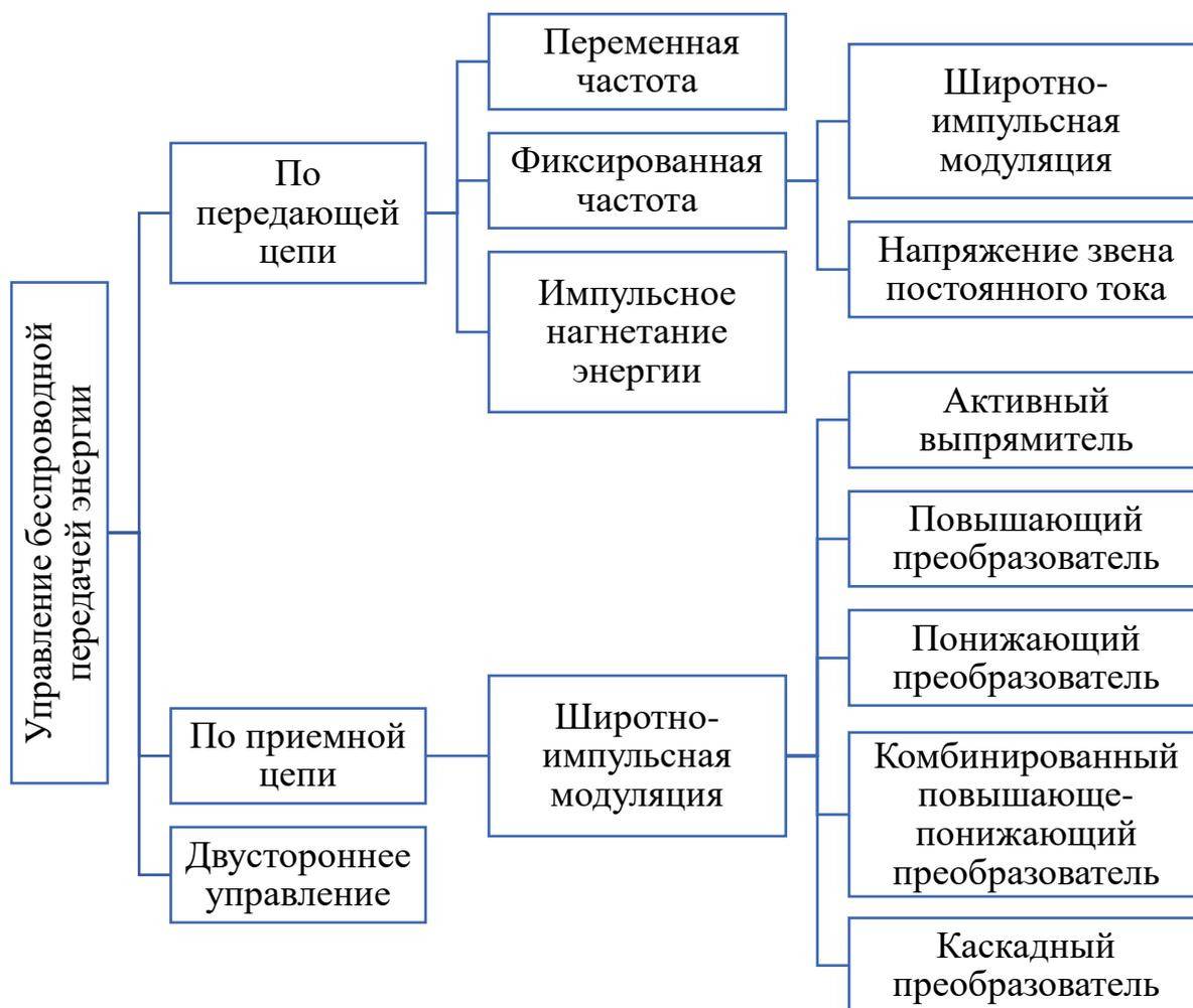
Рисунок 1.31 - Классификация способов управления БПЭ
