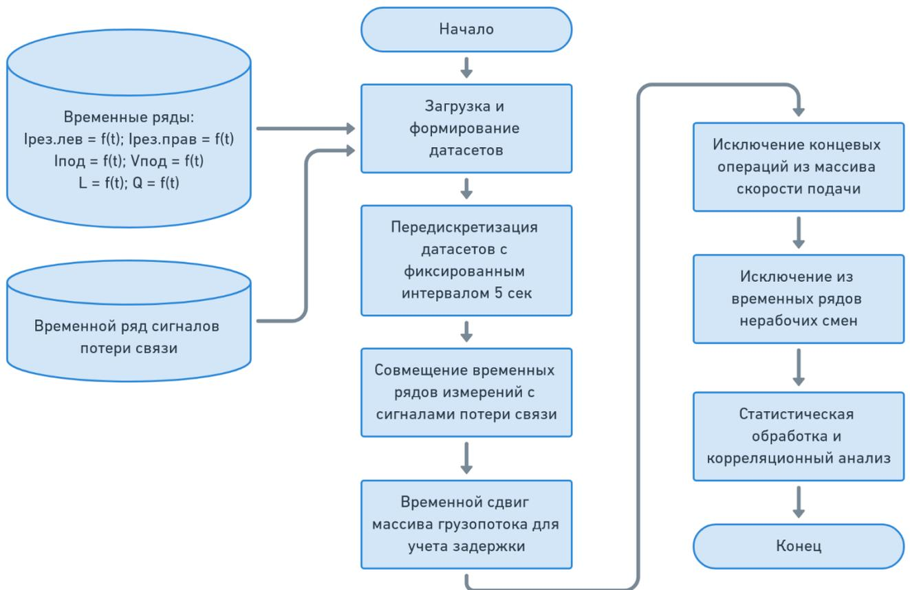
Рисунок 3 – Блок-схема алгоритма обработки массивов данных
