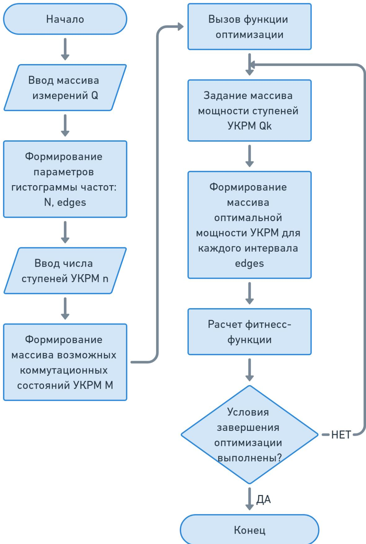
Рисунок 73 – Блок-схема алгоритма выбора оптимальной компоновки УКРМ
