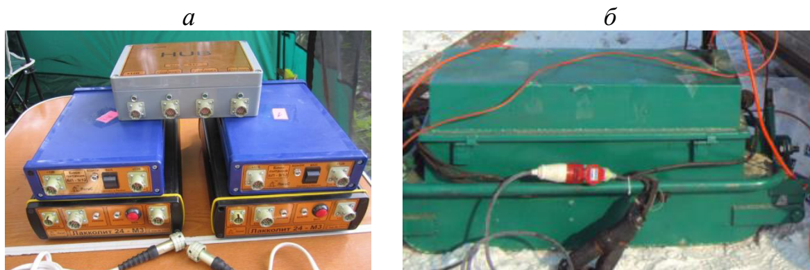
Рисунок 2 — Комплект сейсморазведочного оборудования исследования угольных месторождений: сейсморазведочная станции «Лакколит Х-М3» (а), электромагнитный источник колебаний Геотон-12 (б)
