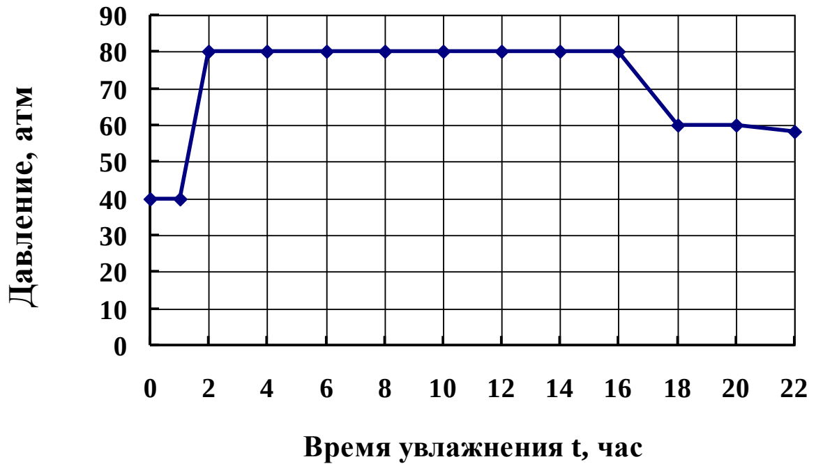
Рисунок 6.11 – Изменение давления нагнетания в процессе увлажнения
