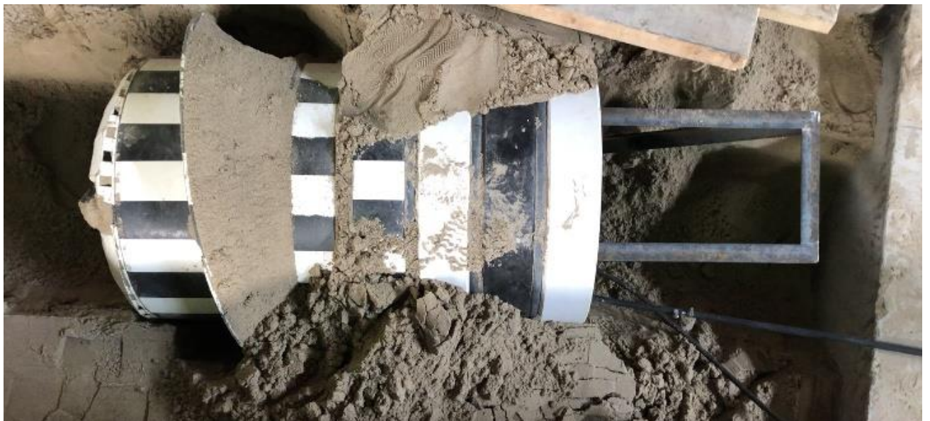
Рисунок 5.22 – Положение ДО геохода после третьего цикла движения
