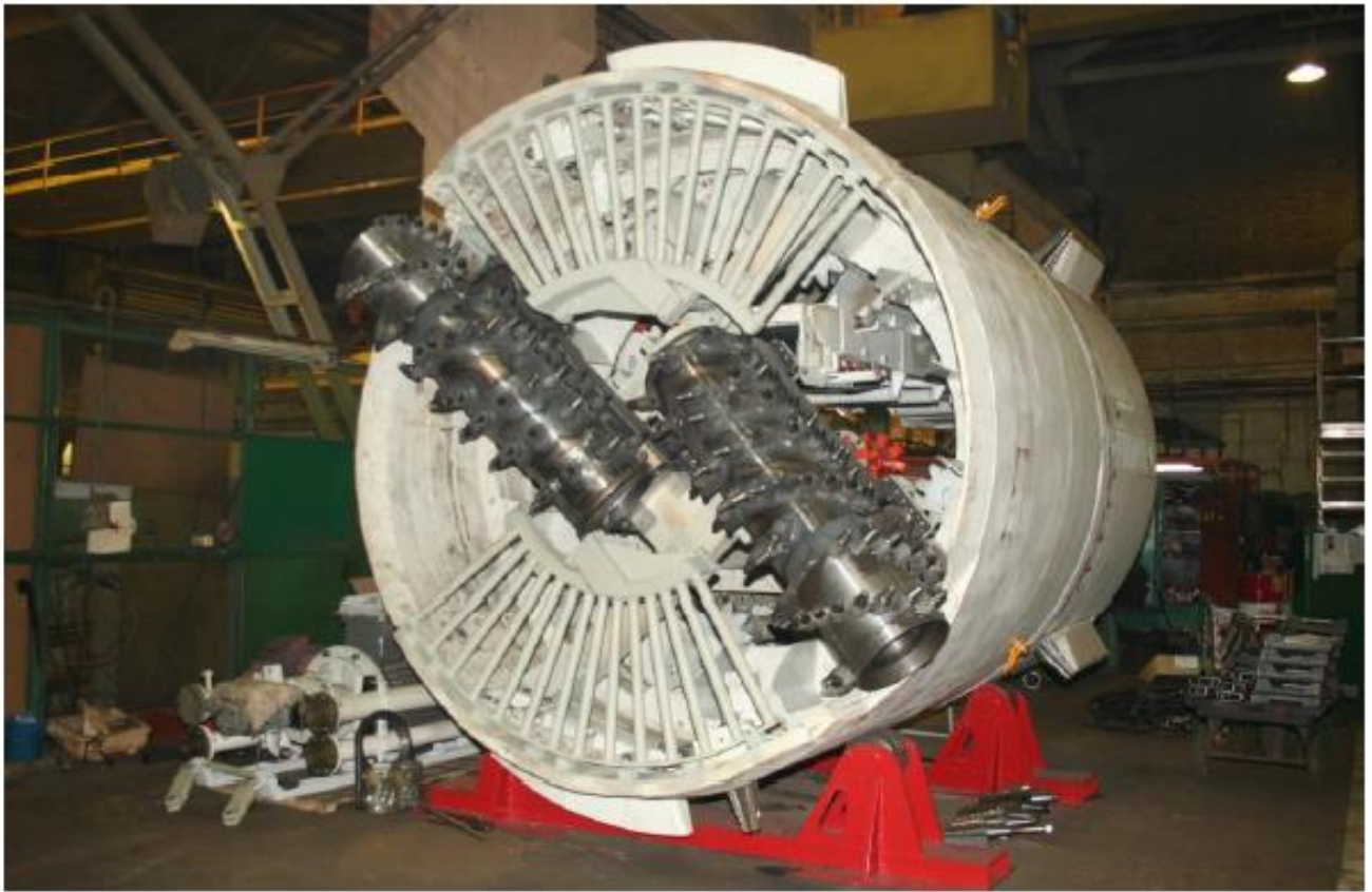
Рисунок 1.3 – Опытный образец геохода модели «401» диаметром 3,2 м
