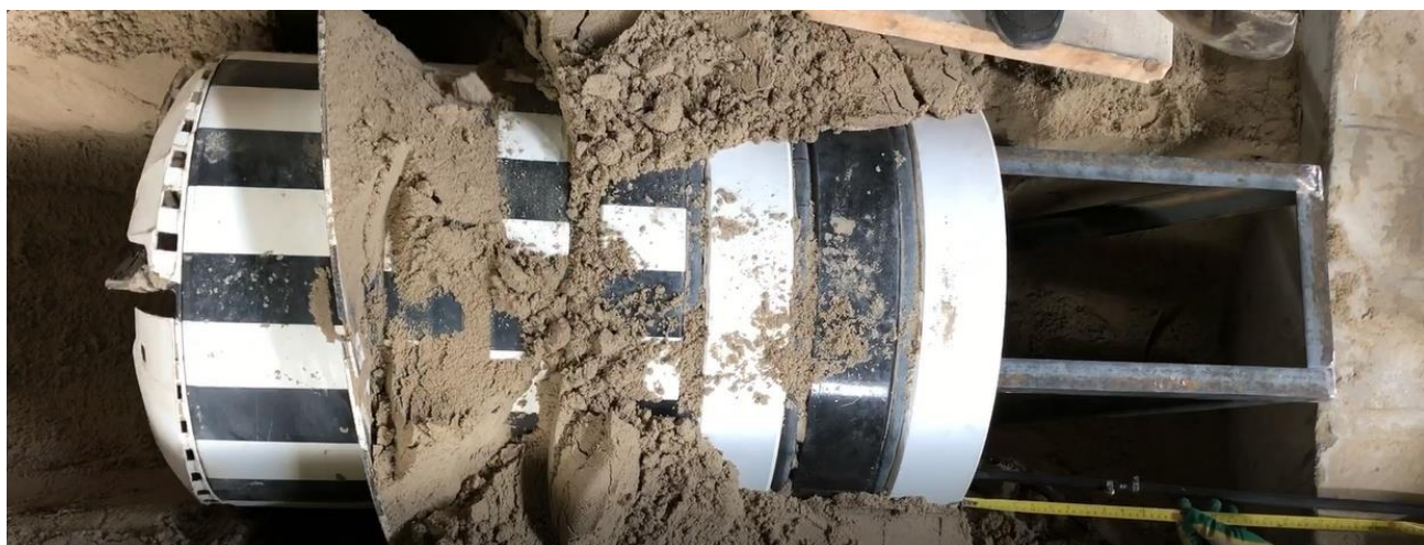
Рисунок 5.20 – Положение ДО геохода после первого цикла движения
