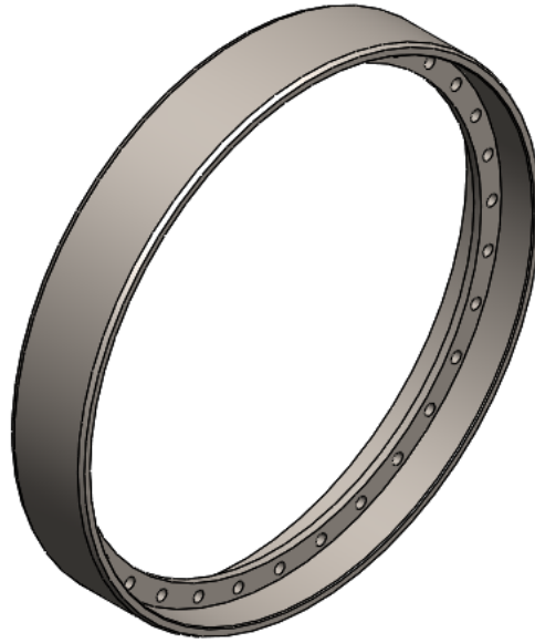
Рисунок 5.9 – Кожух одного кольца тягового модуля
