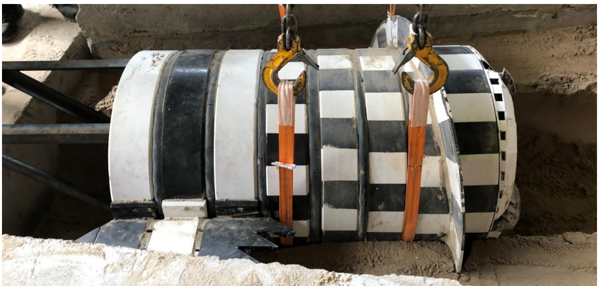
Рисунок 5.18 – Установка ДО геохода на стенде
