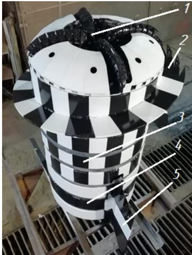
1 – исполнительный орган; 2 – внешний движитель; 3 – тяговый модуль; 4 – опорный модуль; 5 – элемент противовращения
