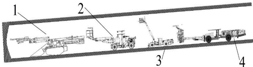
1 – роботизированная буропогрузочная машина 2ПНБ2Б, 2 – зарядная машина Charmec RM 125 с дистанционным управлением, 3 – оборочная машина Scames 2000 с дистанционным управлением, 4 – анкероустановочная машина Atlas Copco Cabletec LC с дистанционным управлением
