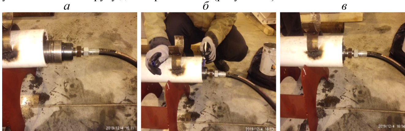
Рисунок 12 – Стендовые испытания пакера в трубе диаметром 105 мм
