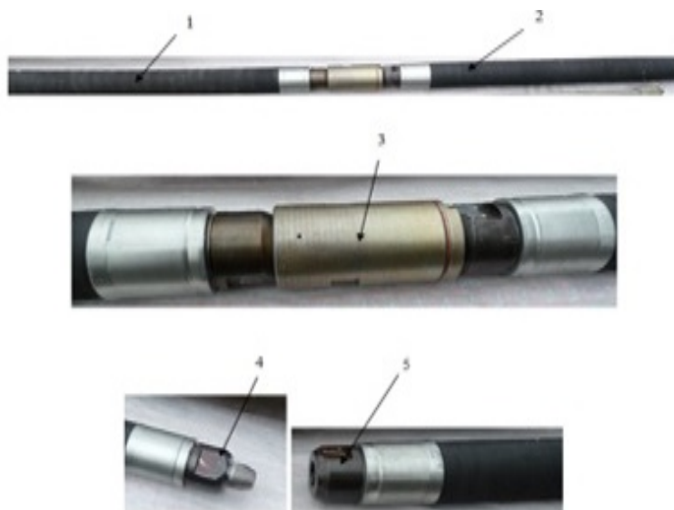
Рисунок 8 – Устройство поинтервального гидроразрыва
