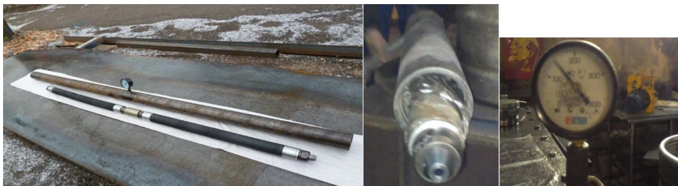
Рисунок 10 – Стендовые испытания устройства поинтервального гидроразрыва в трубе диаметром 80 мм
