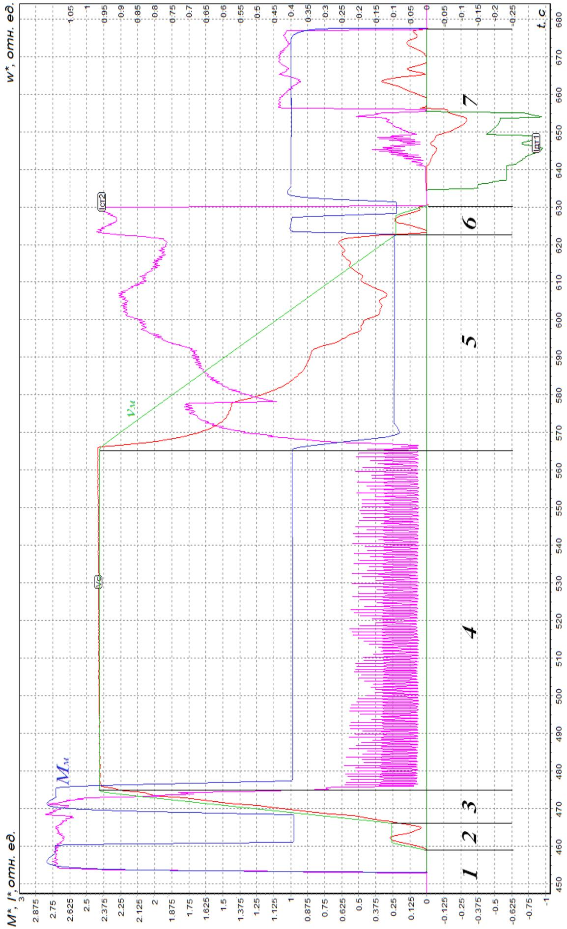
Рисунок 11 – Сравнение переходных процессов модели с переходными процессами реального привода установки ЦР3,5х2,4
