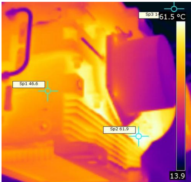
Рисунок 2.14. – Термограмма корпуса редуктора в установившемся режиме работы
