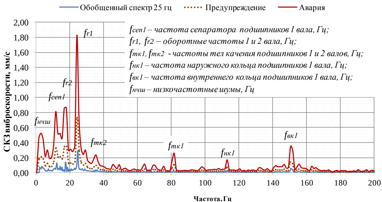
Рисунок 4.11 – Обобщенный спектр а), и опорные маски б), соответствующие обратной частоте 25 Гц
