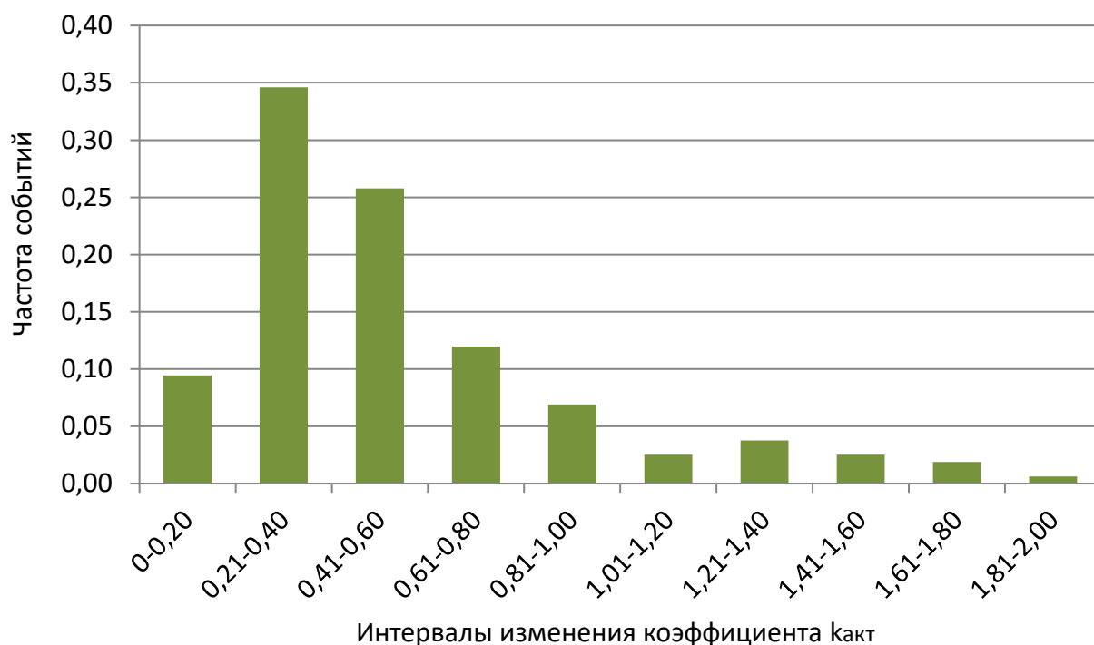
Рис. 1.3. Распределение отношения величин пучения пород почвы на экспериментальных и контрольных участках выработок
