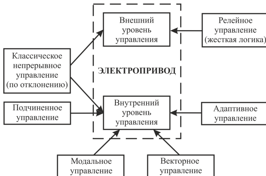
Рисунок 1.1 – Способы управления электроприводом подъема крана
