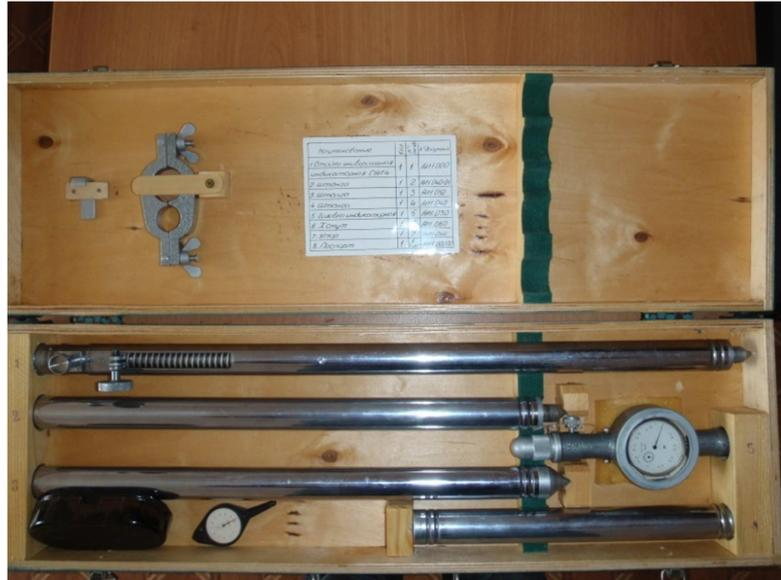
Рисунок 3.3 – Стойка универсальная измерительная СУИ-4 в футляре для транспортировки
