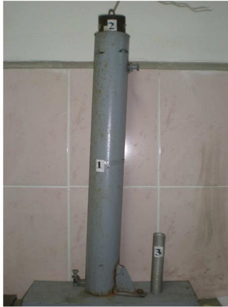
Рисунок 3.13 – Устройство для метода ударного измельчения:
