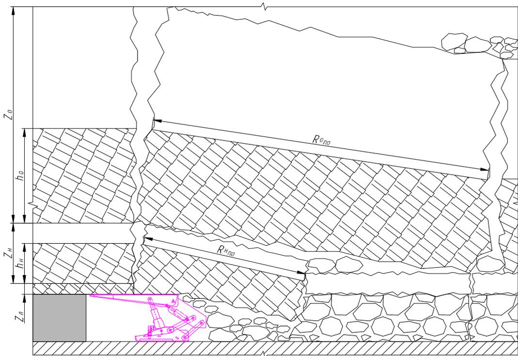
Рисунок 4.7 – Схема для определения ожидаемой нагрузки  $P_{ш}$  от блоков основной и непосредственной кровель при периодическом шаге обрушения
