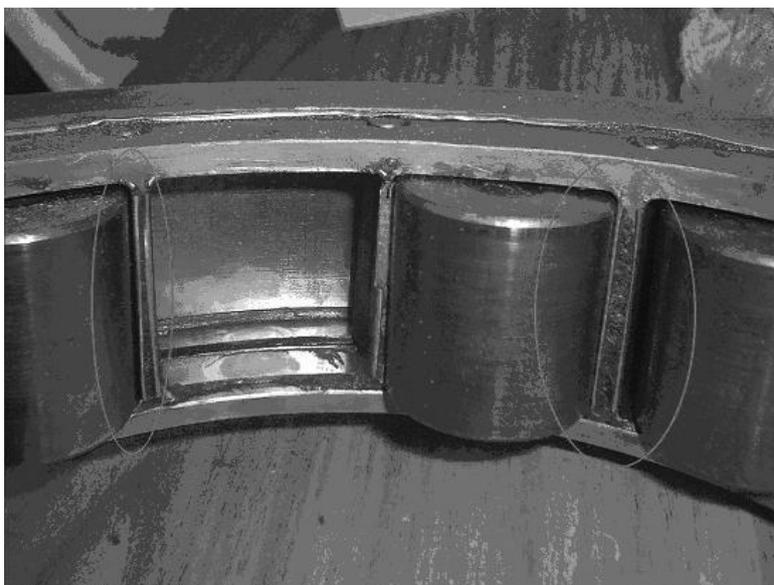
*Рис. 3.6. Износ и разрушение сепаратора*
